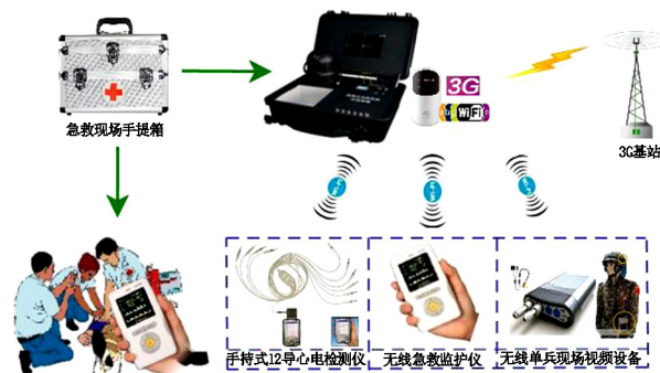
图2 急救现场手提箱系统结构展开图
