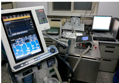
图1 测试设备FLUKE VT-Plus气流分析仪与诺唯主动模拟肺连接
